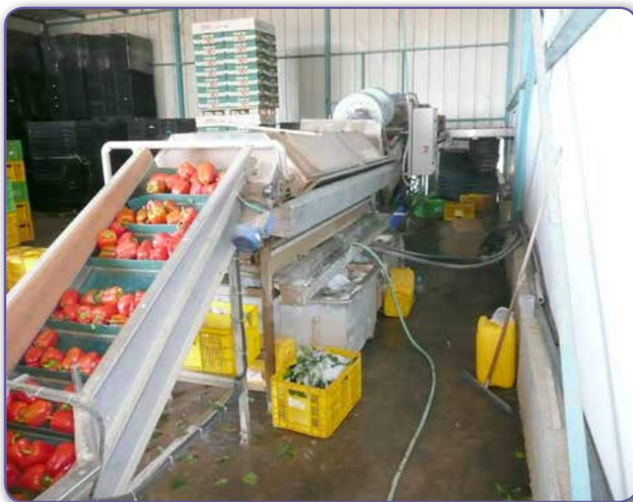
תמונה 2: מערך שטיפה והברשה חמה (55 מ"צ למשך כ-15 שניות) של פלפל מיד לאחר הקטיף ולפני האחסנה הממושכת. צילום: אלי פליק
