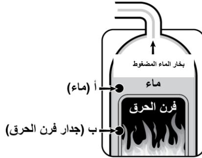
الرسم التوضيحي رقم 7: المرحلة 2 في عملية إنتاج الطاقة من حرق النفايات
