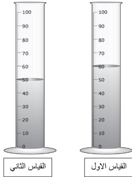
الرسم التوضيحي رقم 8: حجم الأمطار في المخبار المُدرج في القياسين (بالملمتر)
