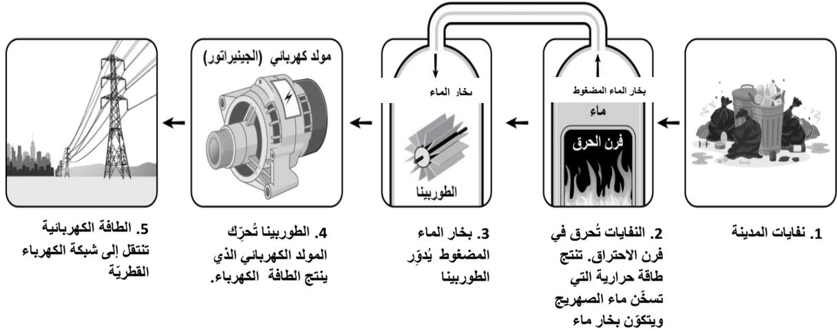
الرسم التوضيحي 3: مراحل عملية حرّق النفايات لإنتاج الطاقة
