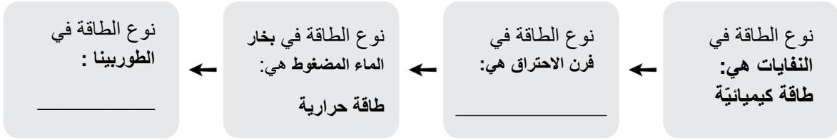
الرسم التوضيحي رقم 6: مخطط يصف تحولات وانتقالات الطاقة في المراحل 2 و 3 في عملية حرق
