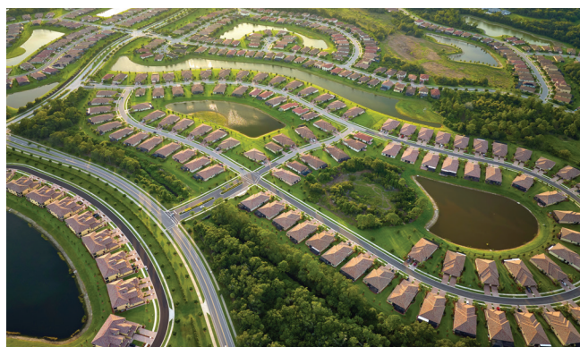
מבט על על בריכות להשהית נגר עלי שהוקמו בשכונה בדרום פלורידה
